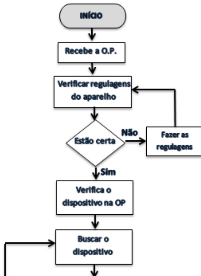
Figura 10- Fluxograma do processo de soldagem
