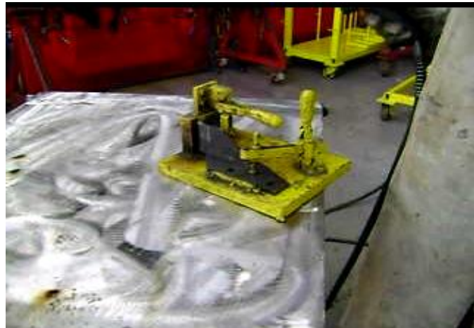
Figura 14 - Posicionamento das partes no dispositivo.
