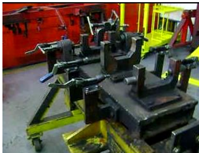
Figura 16 – Dispositivo de soldagem para conjunto médio.
