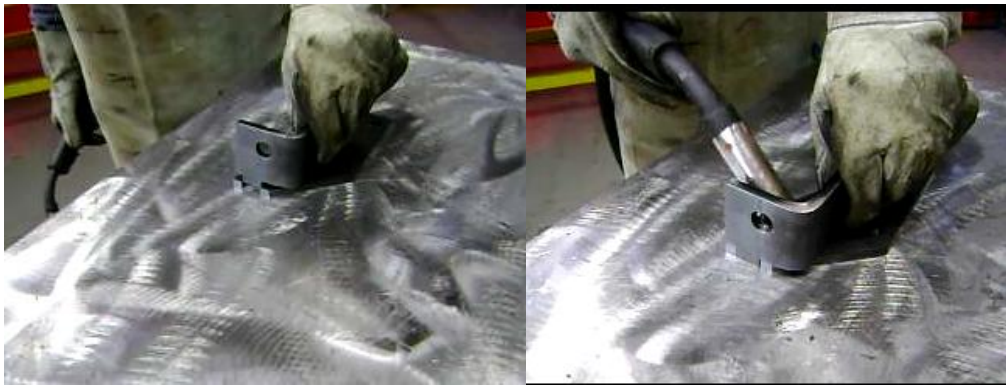
Figura 19 - As partes são posicionadas manualmente e ponteadas.
