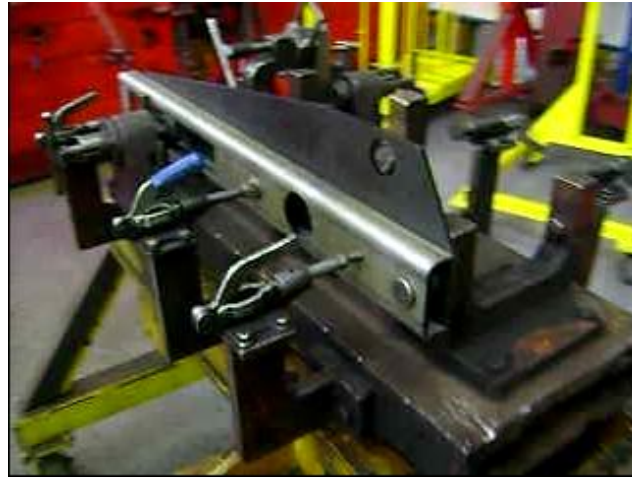
Figura 17- Posicionamento das partes no dispositivo.
