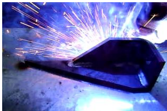
Figura 20 - Soldagem das partes sem auxílio do dispositivo.
