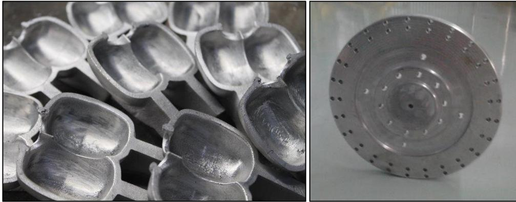
Após as pás e rotor acabados, partiu-se para a montagem final do rotor, conforme a figura 21. Para união das partes (rotor e pás) foi optado por parafusos sextavados M8.
