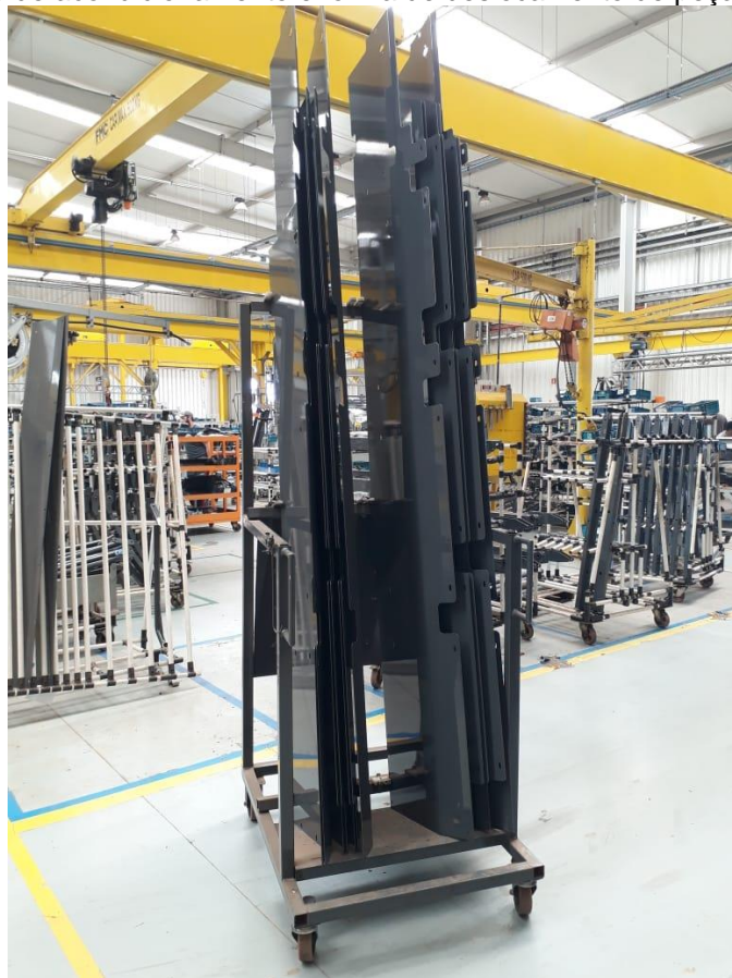
Figura 17 - Novo carro de acondicionamento e forma de deslocamento de peças.
