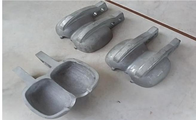
Figura 6 – Protótipo da Pá fundida em alumínio
