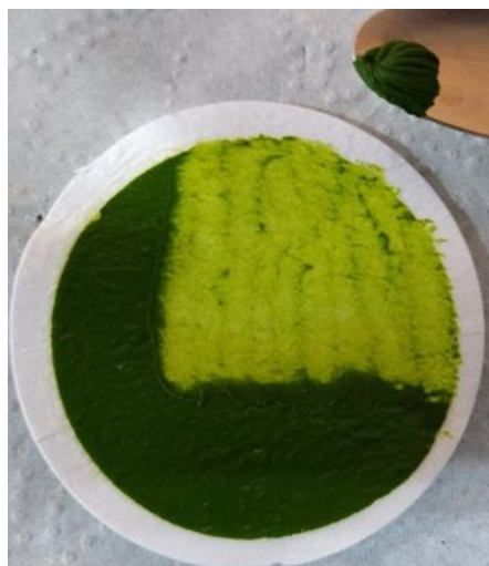
Figura 31 - Remoção da biomassa retida no microfiltro após processo de filtração a vácuo.
