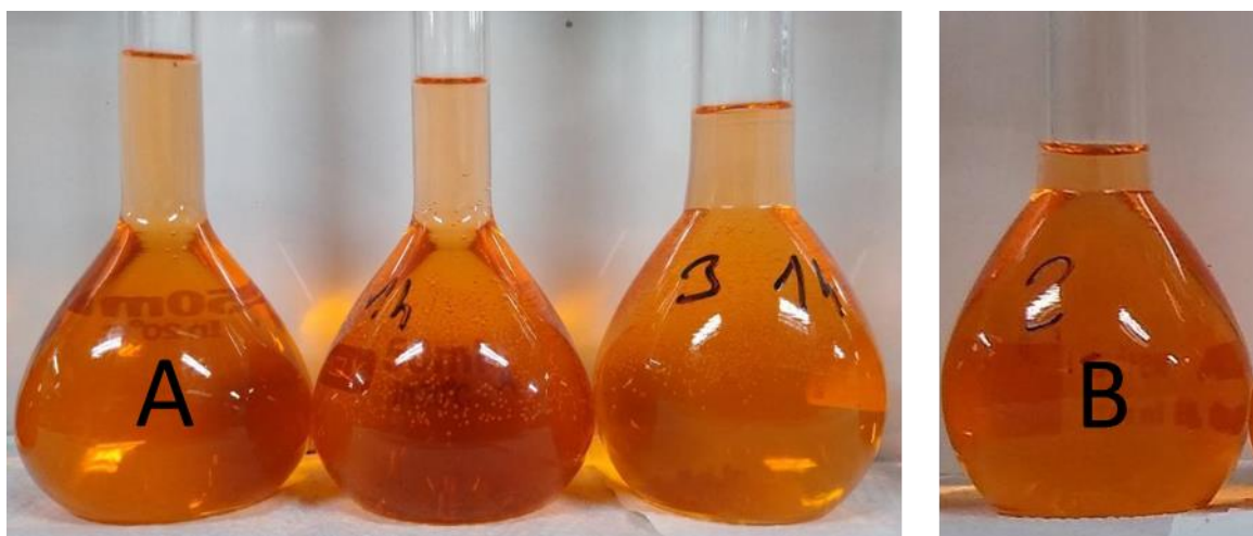
Figura 39 - Comparação visual de coloração das análises do grupo 2 com um ponto da curva de calibração.
