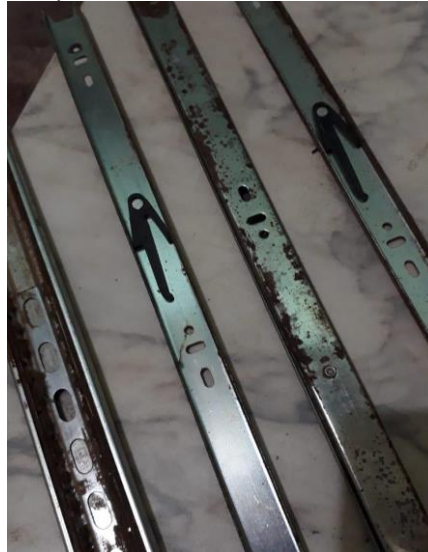
Figura 17 - Trilhos corrediços telescópio danificados
