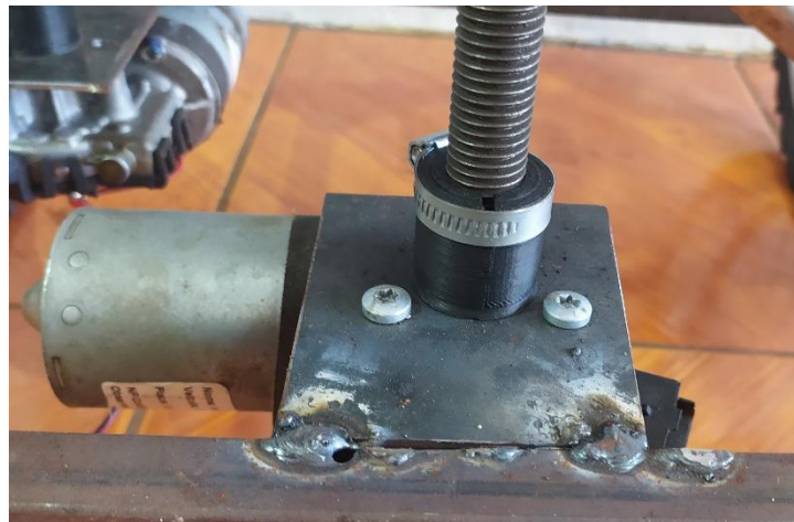
Figura 18 - Fixação dos motores
