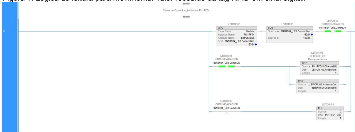
Figura 4: Lógica de leitura para movimentar valor recebido da tag RFID em sinal digital.
