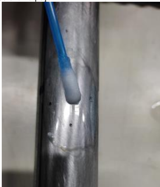
Figura 20 – Aplicação da acetona na peça
