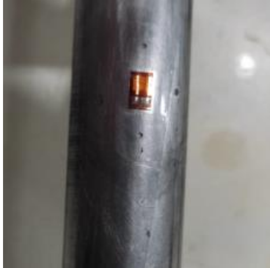
Figura 24 – Posicionamento do Strain gage na peça
