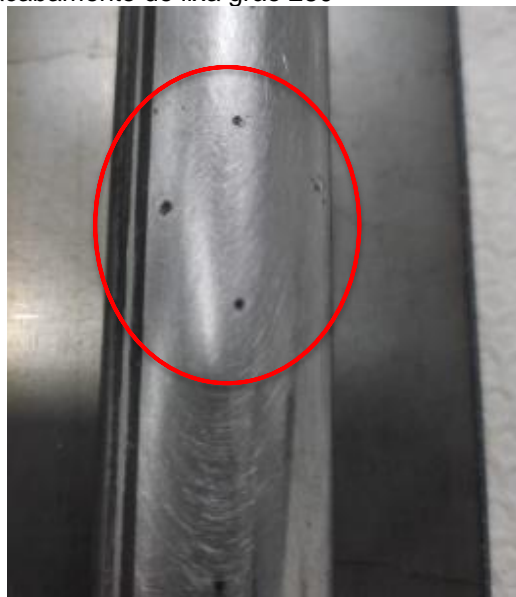
Figura 17 – Superfície com acabamento de lixa grão 280
