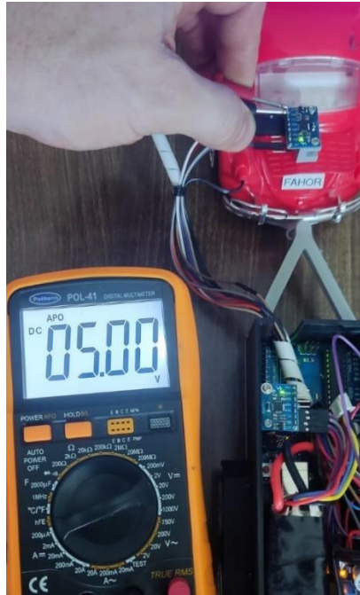
Figura 10 - Multímetro indicando a tensão de alimentação do sensor giroscópio
