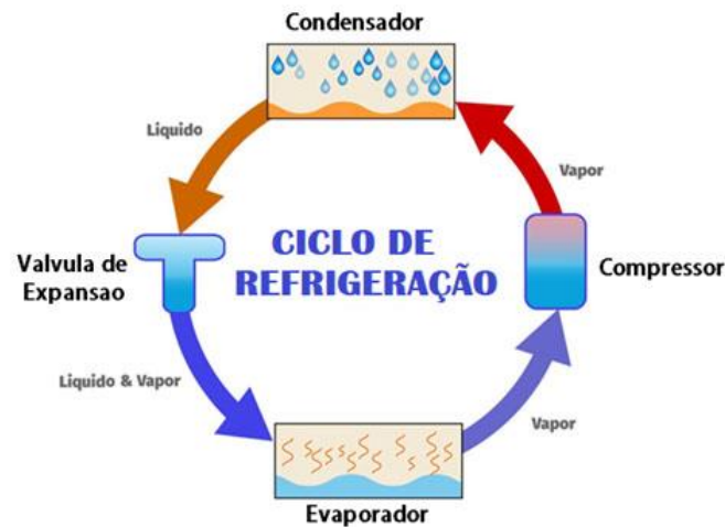
Figura 2 – Esquema do compressor em sistemas de HVAC-R. 2022
