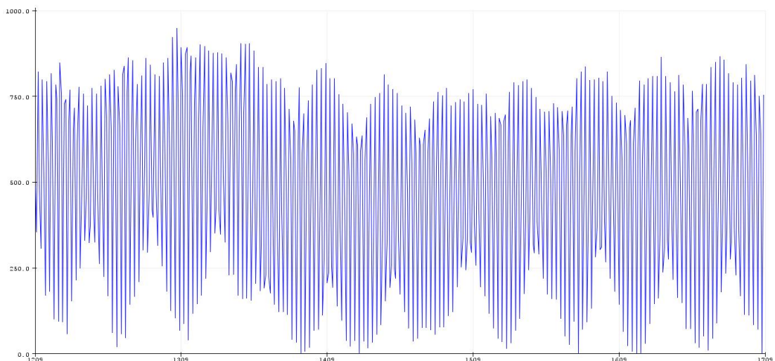
Figura 38 - Sinal de vibração obtido com duas massas de desbalanceamento a 90^\circ .
