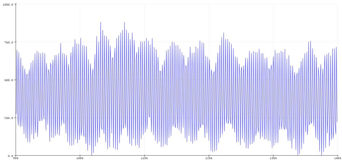
Figura 32 - Sinal de vibração obtido com uma massa de desbalanceamento
