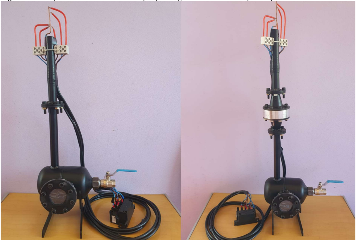
Figura 25 – Dispositivo sem corta chama(esquerda), com corta chama (direita).
