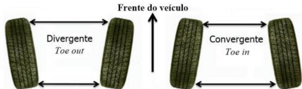
Figura 5 – Convergência e divergência das rodas
