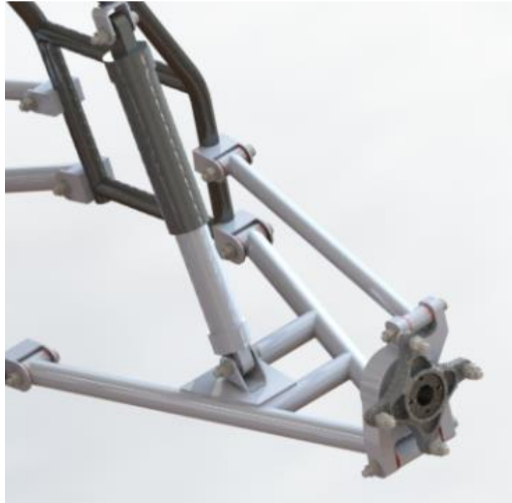
Figura 20 – Suspensão traseira montada no chassi
