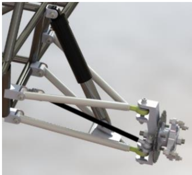
Figura 19 – Suspensão dianteira montada no chassi
