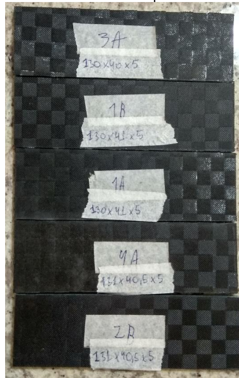
Figura 52 – Corpos de prova para o ensaio de Flexão em 3 pontos
