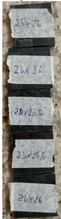
Figura 48 – Corpos de prova para o ensaio de Compressão Transversal
