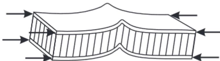
Figura 24 – Flambagem de um painel sanduíche
