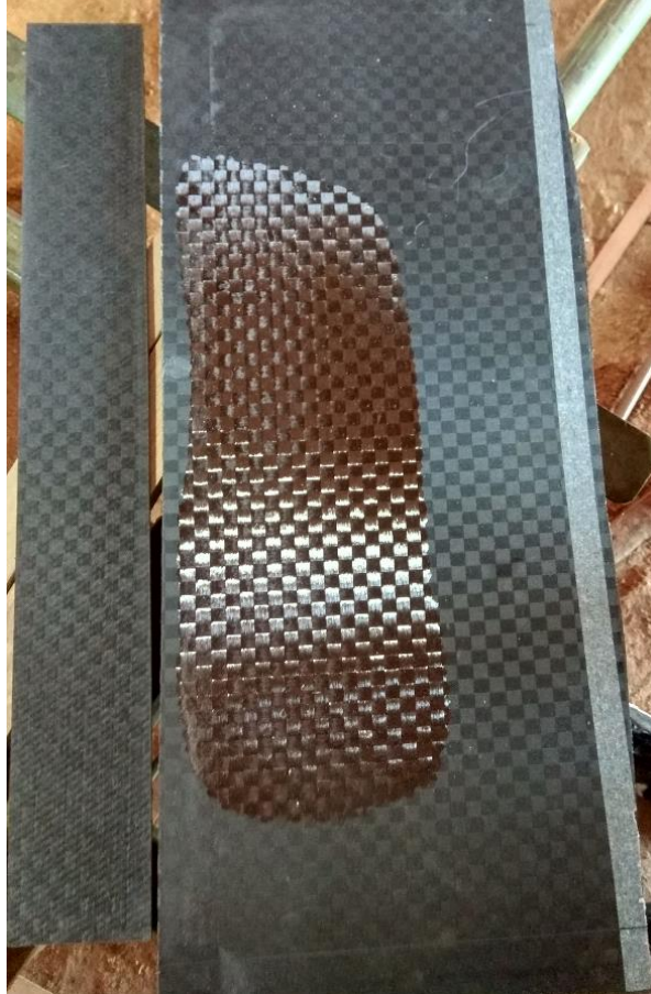
Figura 41 – Resultado da infusão da placa final
