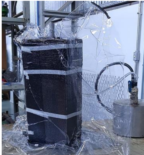
Figura 30 – Sacola de vácuo em torno dos materiais
