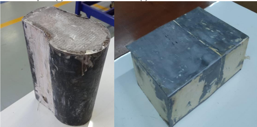
Figura 35 – Molde perna (a) e molde caixa de baterias (b)
