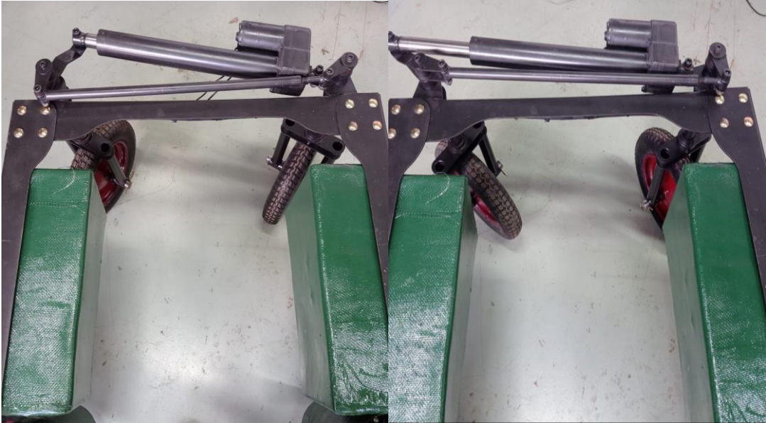
Figura 46– Retração do atuador (a) e atuador avançado (b)
