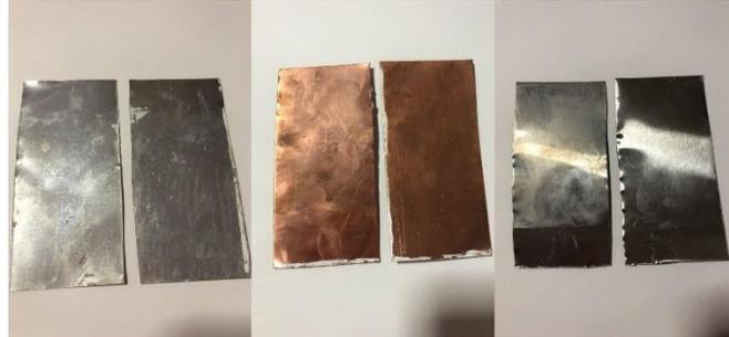
Separou-se os mesmos por um material não condutor de energia (borracha). Adicionou-se um eletrólito, sal de cozinha (NaCl), 0,1 g para 500 mL de solução, com intuito de acelerar e facilitar o tratamento de eletrofloculação.
