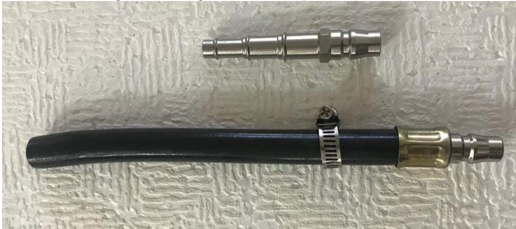
Figura 15 - Mangueira a conexão para a transmissão
