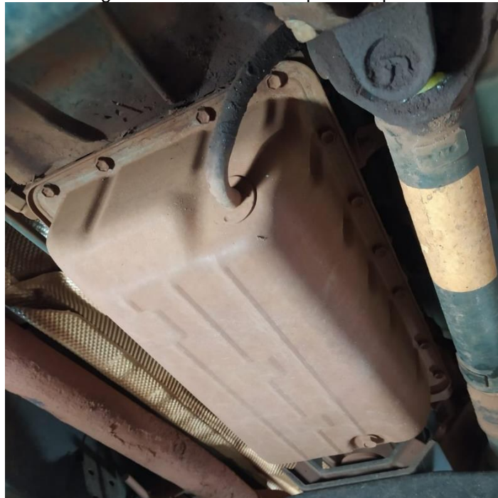
Figura 22 - Cárter fixado após a limpeza
