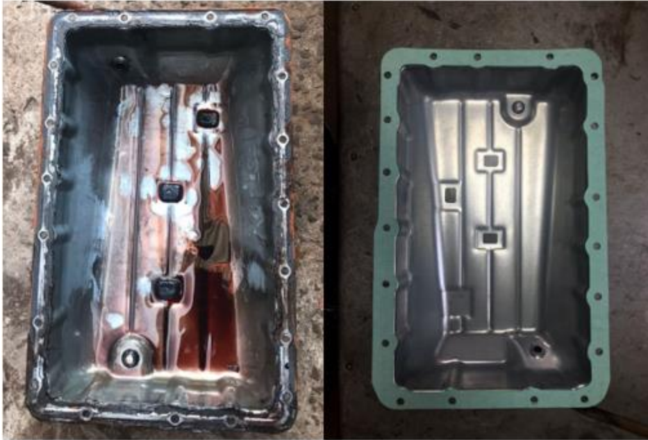
Figura 19 – Limpeza do cárter da transmissão automática
