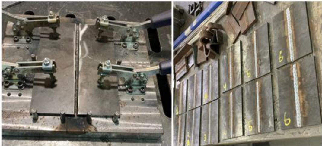
Figura 19 – (a) Peças montadas no dispositivo e posicionadas para soldagem e (b) corpos de prova após a soldagem.
