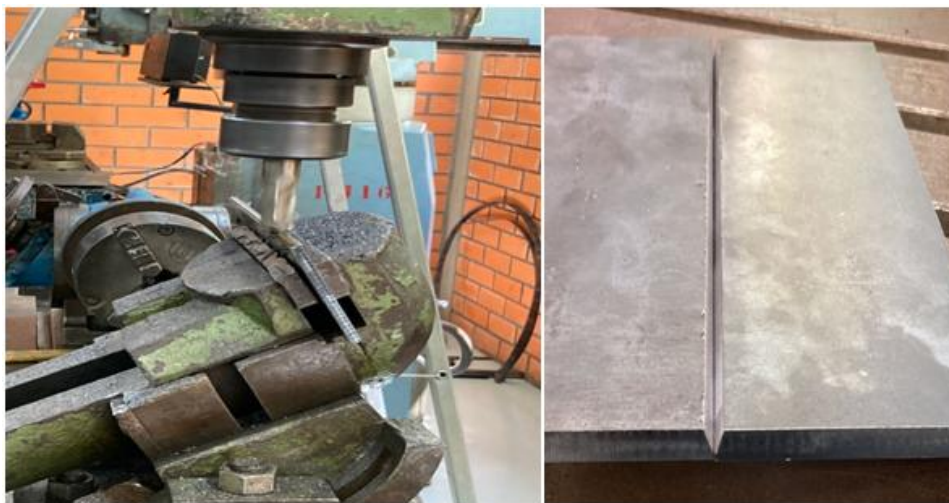
Figura 17 – (a) Fresadora ferramenteira; e (b) corpos de prova fresados.
