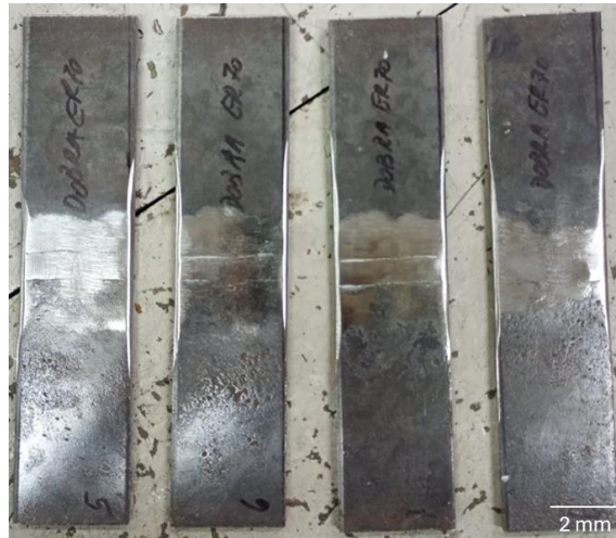
Figura 17: Corpos de prova para ensaio de dobramento
