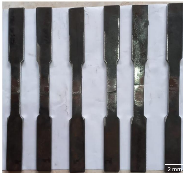
Figura 16: Corpos de prova ensaio de tração
