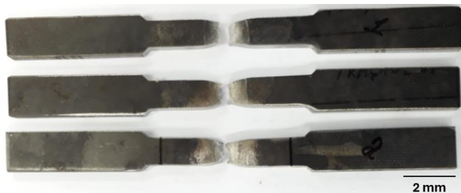
Figura 24: Corpos de prova de tração (AWS ER70S-6)
