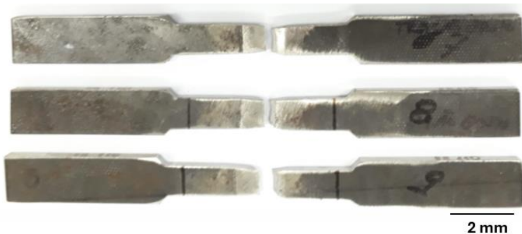
Figura 25: Corpo de prova de tração (AWS ER110C-G H4)
