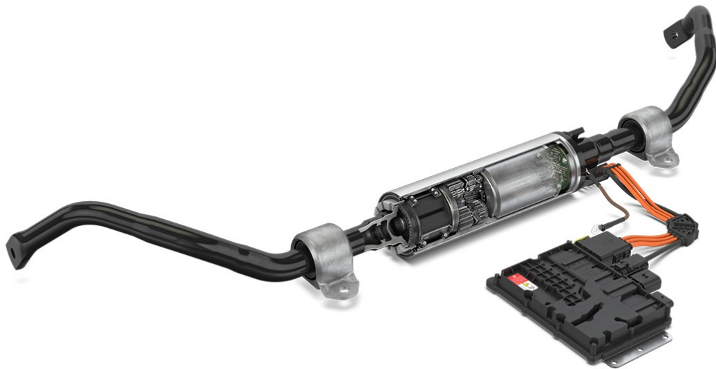
Figura 12: Barra Estabilizadora Ativa desenvolvida pela Schaeffler
