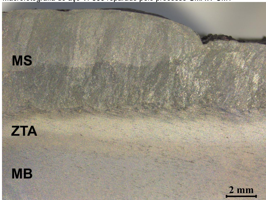
Figura 17 – Macrofotografia do aço VF800 reparado pelo processo GMAW-CMT
